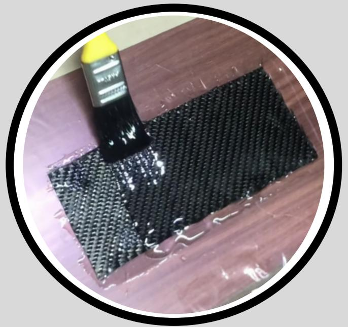
Resina con gran penetración y humectación en fibras y tejidos de vidrio, carbono, kevlar, etc.
