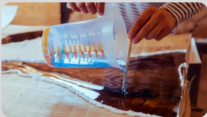
Resina para colada con buena impregnación de cargas o laminado de plástico reforzado con fibra de vidrio que requieran alta traslucidez.
